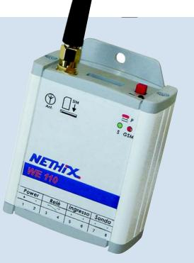
**Well0** permette di azionare e regolare dispositivi elettrici con l'invio di messaggi SMS da telefono cellulare GSM. Può essere utilizzato nelle più svariate applicazioni di telecontrollo e "home automation".
